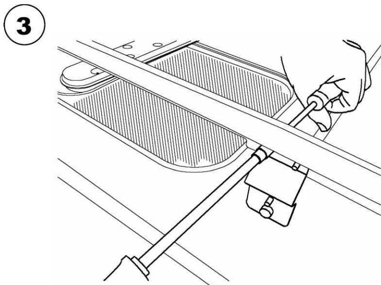
3. Снять штанги для ополаскивания и соответствующие кронштейны.
