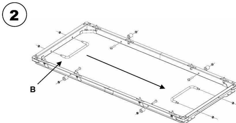
2. Снять ручку «В» и заново закрепить ее с противоположной стороны.
