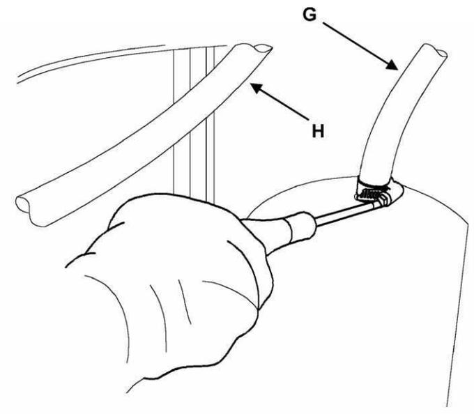
Внутри (на бойлере) обнаружатся части трубок, с помощью которых на противоположной стороне подключаются штанги ополаскивания.
