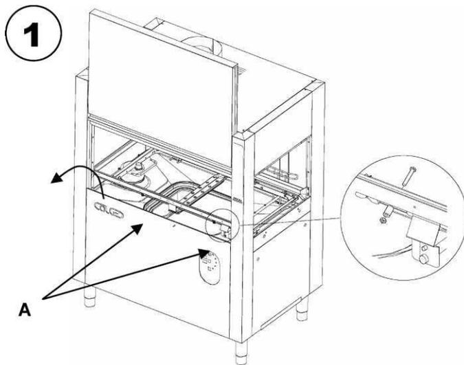
1. Снять «стопор скользящей каретки», вывинтив винты А, затем извлечь скользящую каретку.
