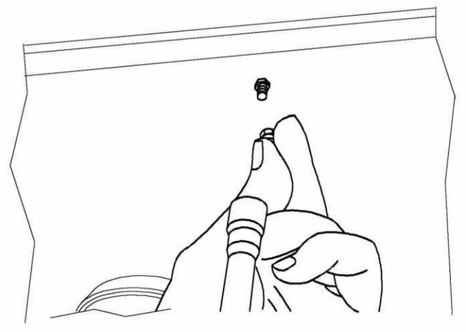
Заново собрать на противоположной стороне, предварительно сняв колпачковые гайки.
