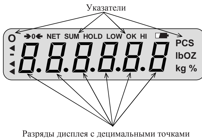
Рисунок 4.3 – Расположение указателей и разрядов дисплея
