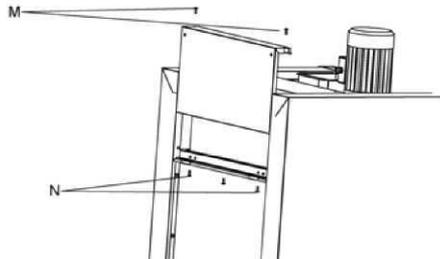
19. Вставить верхнюю боковую панель, снятую с позиции над выпускным отверстием машины:
