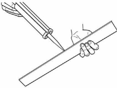
7. После того, как все поверхности будут тщательно почищены, можно приступать к сборке модуля. Подготовить нижнюю панель (см. стр. 2, п. 7 перечня компонентов и таблицу расположения), поместив с каждой стороны немного силикона.
