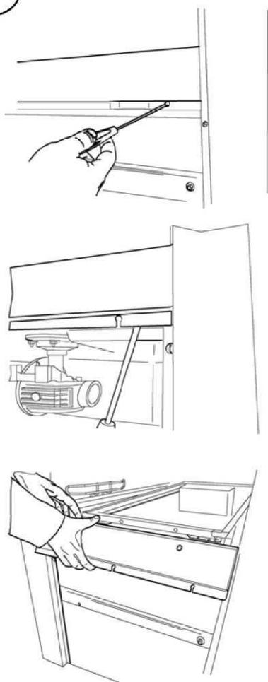
4. Снять раму, используя отвертку в качестве рычага; при необходимости удалить силикон с помощью ножа.
