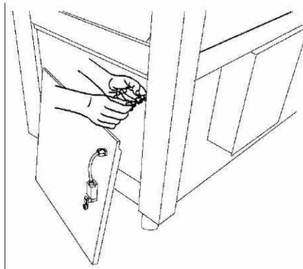
21. Вставить нижнюю боковую панель, подключив предварительно концевой микровыключатель.
