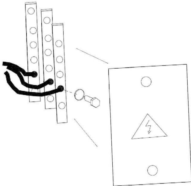
Снять пластиковую защиту и подсоединить кабели к планкам питания, включая провод заземления. Убедиться в наличии на винтах стопорных шайб и плотно их завинтить. Установить на место пластиковую защиту.
