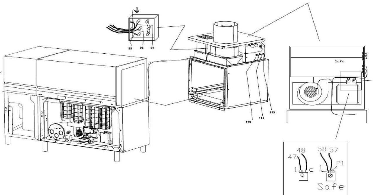
Обычно блок сушки поставляется полностью собранным. В любом случае необходимо проверить правильность соединений, сравнив их с рисунком выше. Также следует проверить все соединения для заземления.
