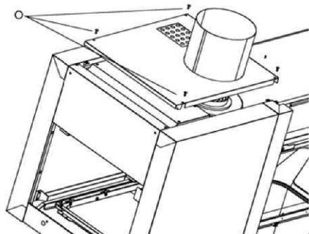
20. Поместить крышку модуля сушки (п. 9), как показано на чертеже; закрепить с помощью винтов O.
