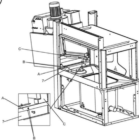
11. Установить модуль сушки, сначала вставив нижнюю часть, таким образом, чтобы сгиб «А» опирался на только что установленную панель «7»; совместить крепежные отверстия «В».
