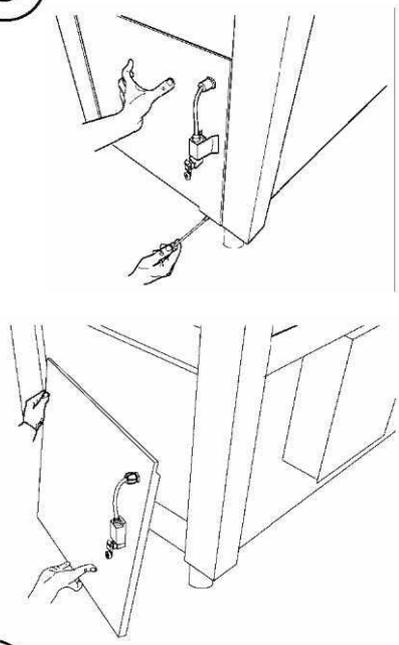
3. Снять боковую панель, чтобы получить доступ к крепежным винтам на боковой раме.
