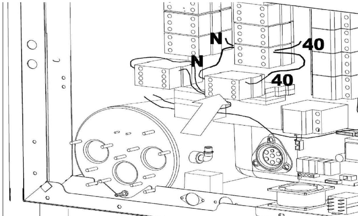
Подсоединить кабели N и 40 контактора, показанного на рисунке, соответственно к клеммам прилегающего контактора.
