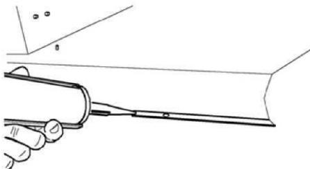
Также нанести силикон на верхнюю часть машины (как показано на рис.).
