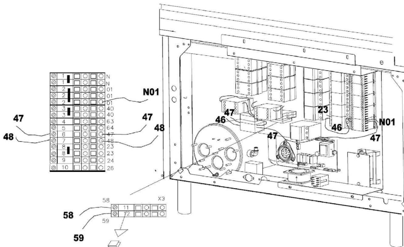
Достать перемычку с клемм 11 и 12, и подсоединить электрические кабели к соответствующим клеммам, как показано.
