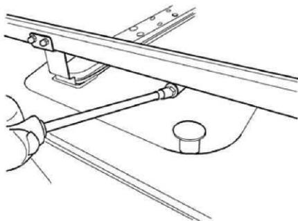
15. Прикрепить направляющие корзины к пластиковой опоре **С** с помощью имеющихся винтов, **до того, как вставлять крюк.**
