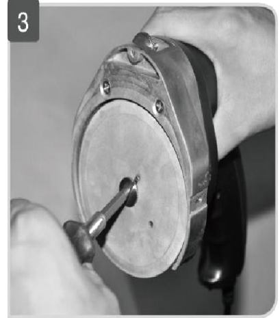
Рис.6 Снятие защитного кожуха, снятие диска
