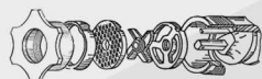
набор для измельчения мяса (с применением решетки d отверстий 5 мм, либо решетки d отверстий 9 мм)
