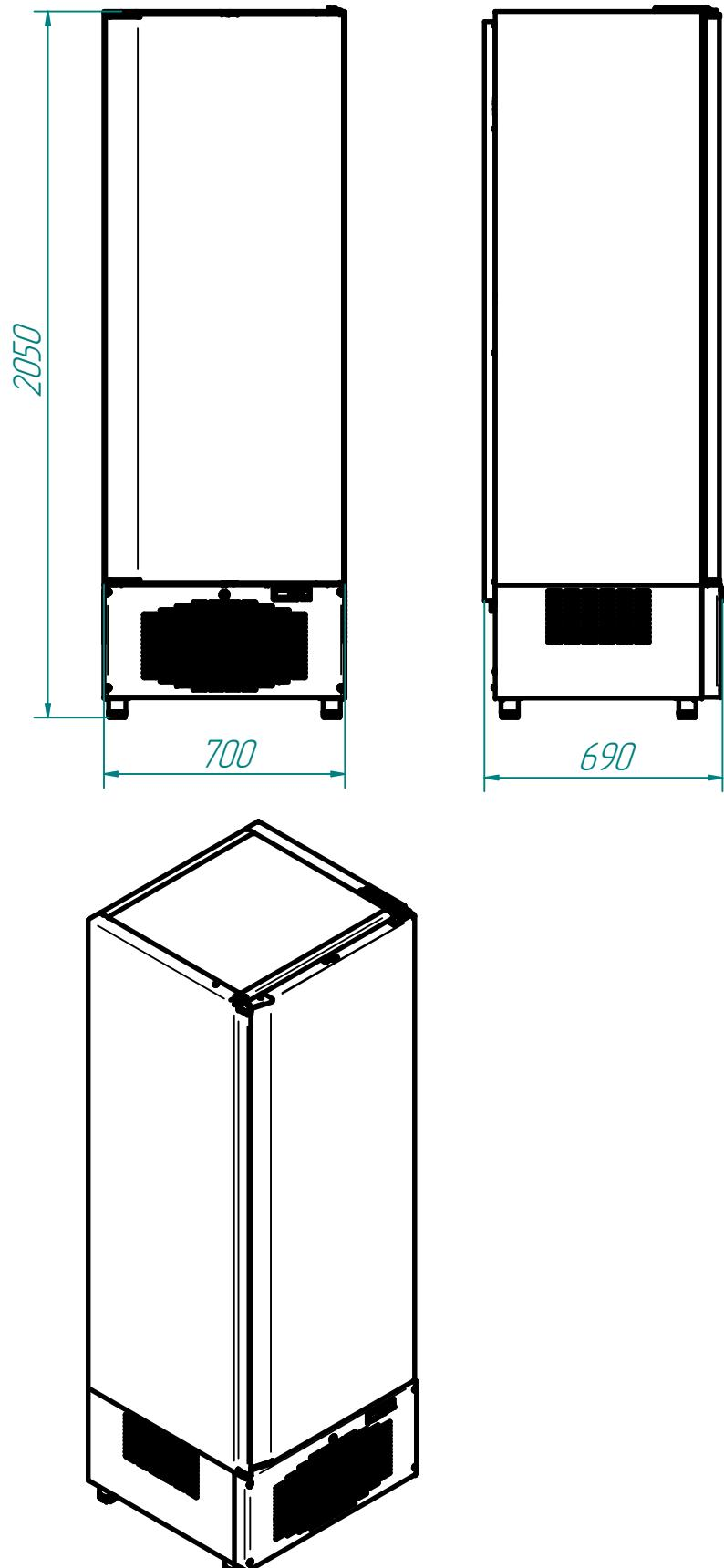
Шкаф холодильный типа ШХ-0,5 (ШХн-0,5;ШХс-0,5) с нижним расположением агрегата предназначен для хранения пищевых продуктов в охлаждённом или замороженном состоянии на предприятиях общественного питания и торговли.
