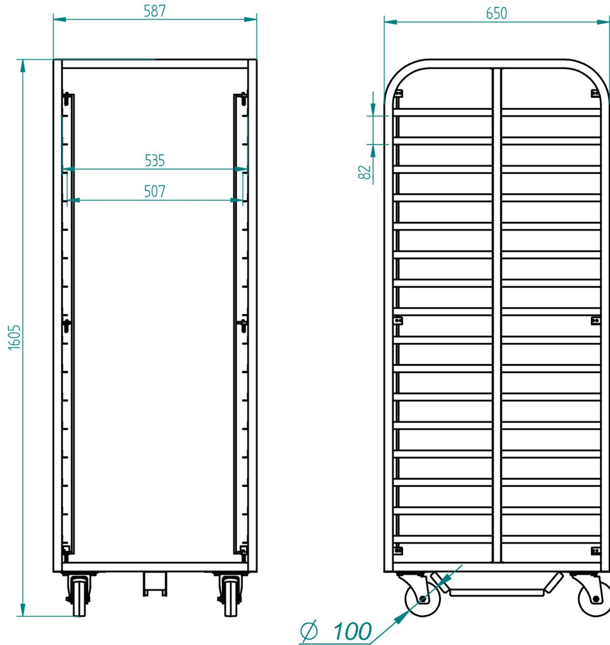
Тележка-шпилька ТШГ-16-2/1 является вспомогательным оборудованием для предприятий общественного питания и для установки и транспортировки до 16-ти гастроемкостей размером GN 2/1 (до 32-ти гастроемкостей GN 1/1). Имеет поворотные колеса. Допускается использовать в ротационном пекарском шкафу РПШ при приготовлении блюд ввиду использования в тележке-шпильке термостойких колес.
