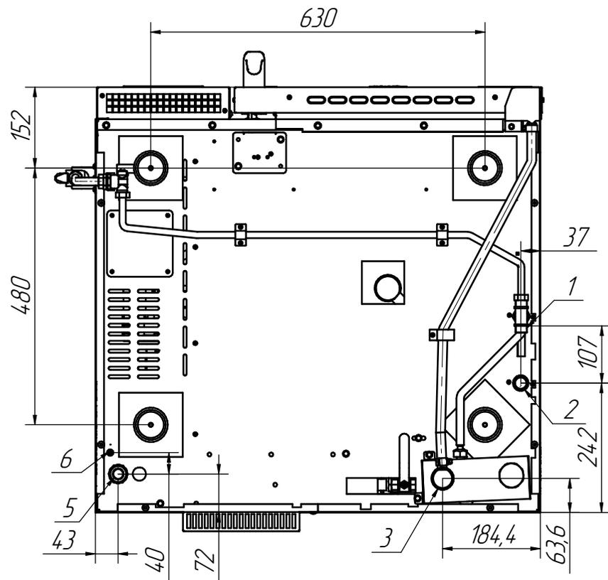
Схема подключения ПКА6-1/1ПМ2, ПКА10-1/1ПМ2
