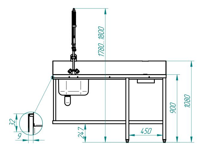
Стол имеет отверсите для сбора крупных отходов, ванну для предварительного ополаскивания посуды, душирующее устройство для холодной и горячей воды, регулируемые по высоте задние ножки, место для установки кассет 500х500 мм. Крепление к посудомоечной машине осуществляется с помощью верхнего зацепа и нижних винтов. Путем несложного монтажа стол можно установить как в левом, так и в правом исполнении.
