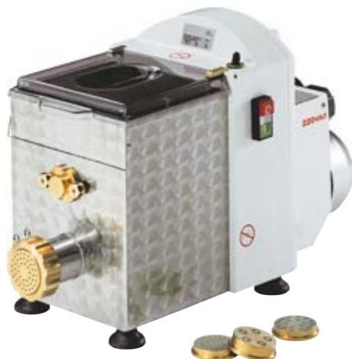
Эта машина подходит даже для яичной пасты различных форм. Корпус покрашен краской, устойчивой к механическим повреждениям, емкость для замеса и месильный орган выполнены из нержавеющей стали, матрицы из сплава бронзы/латуни. Оснащена 2 микропереключателями безопасности, расположенными на крышке месильной емкости. Модели MPF4 и MPF8 стандартно идут с охлаждением зоны экструдирования.
