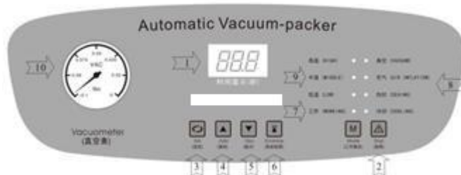
Рис. 6 Электронная панель управления оборудования.
