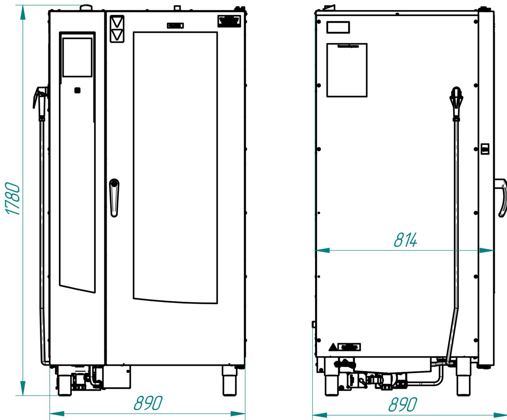
Пароконвектомат предназначен для приготовления различных блюд как в ручном режиме, так и с использованием **готовых программ приготовления**. Встроенная функция **автоматической мойки** позволит быстро и качественно очистить камеру без участия человека.
