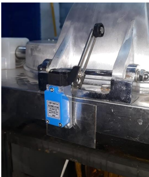
Рис.3 – Концевой выключатель на открытие верхней защитной крышки.
