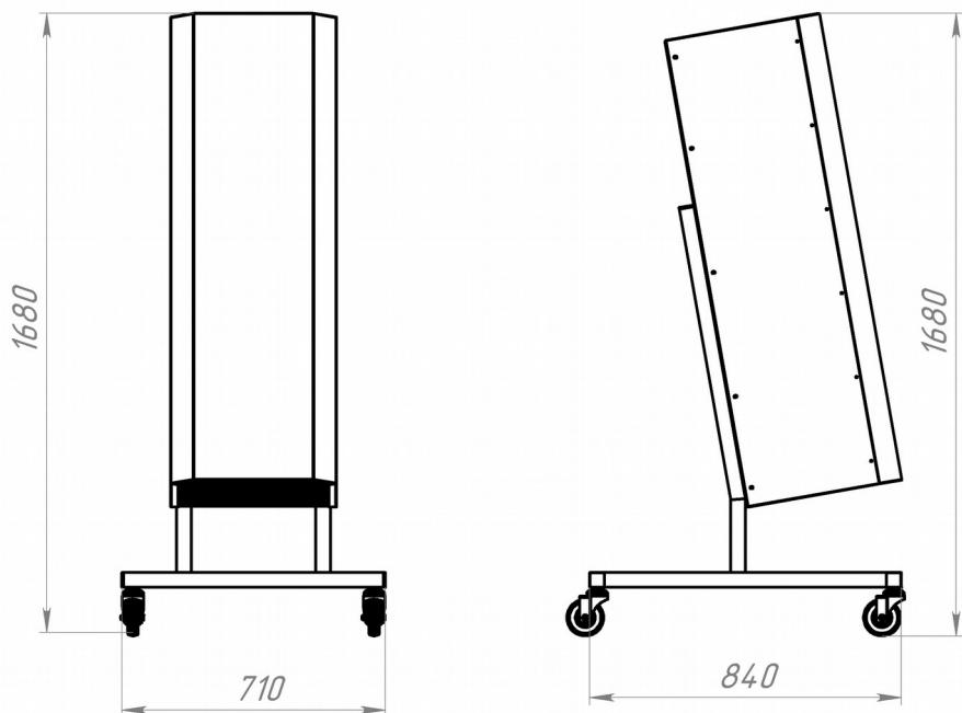
Рис.1 Общий вид облучателя-рециркулятора бактерицидного ОР-УФ-600СО.
