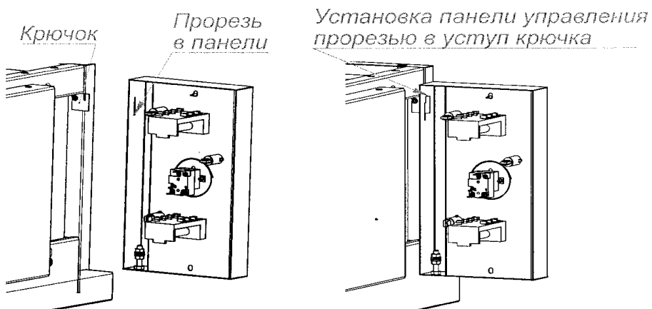
Рис.6 Схема установки панели управления при ТО
