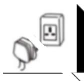
Электропитание аппарата осуществляется от сети переменного тока напряжением 220 В, частотой 50 Гц. Питание однофазное отдельной трёхконтактной розетки.
