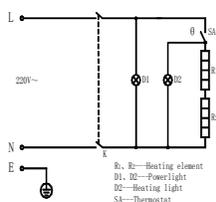
Heating element – нагревательный элемент
