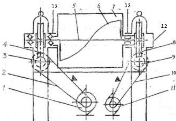
Принцип действия тестомесильной машины — емкость для приготовления теста (дежа) имеет горизонтальный вал, на котором размещены лопасти в форме S
